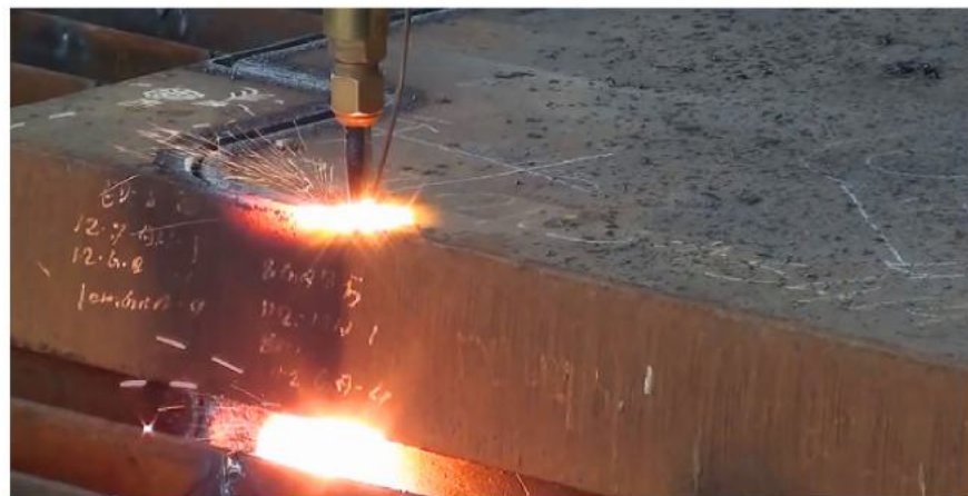
火焰切割 Flame Cutting
